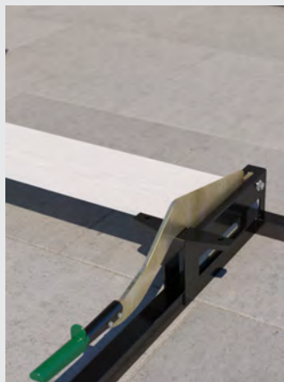
Hardie™ Giljotiin lõikeriista kasutamisel peab laua värvitud pool olema ülespoole suunatud.
