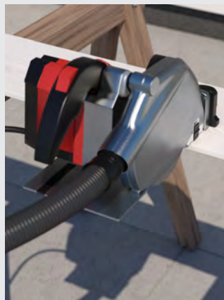
Hardie™ Blade saetera kasutamisel nõuab enamik ringikujulisi saage, et laudade värvitud pool oleks allapoole suunatud. Soovitame seda enne lõikamist mitmekordselt üle kontrollida.
